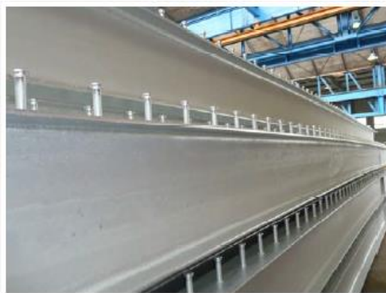
Slika 3: Vruće pocinčani most u Njemačkoj u proizvodnji
