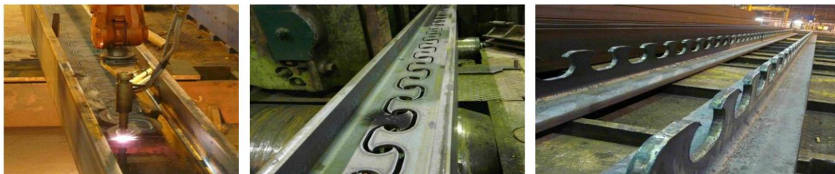
Slika 36: Projektiranje i izrada Precobeam sustava u radionici Arcelor Mittal
