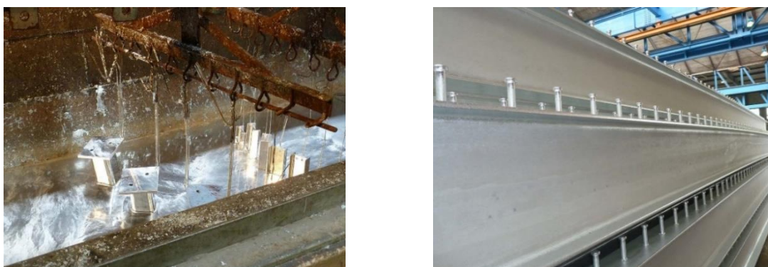
Slika 10 : Vruće cinčanje čeličnih komponenata (a) Uklanjanje iz kade (b) Vruće pocinčani nosači
